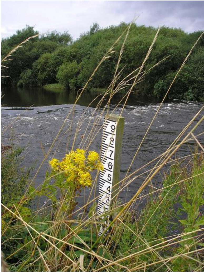
Rajah 6: Contoh tolok aras air yang dipasang di lokasi-lokasi strategik sepanjang sungai
